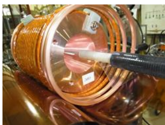
図 5 : FC 試験コイルと磁場計測
