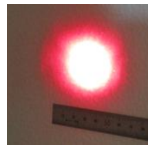
図6 : 500m 先でのレーザースポット ( 4\sigma=30\text{mm} )
