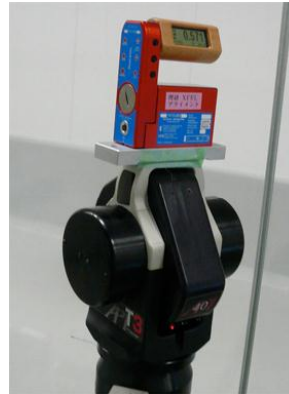
図 8. Wyler 水準器設置位置
