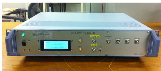
図 1 : ARES 空洞シミュレータ (三光社* 製造)。RF 入力信号に対し、各空洞の応答および反射信号を RF 信号で出力する。チューナー制御による共振周波数の変化にも対応する。
