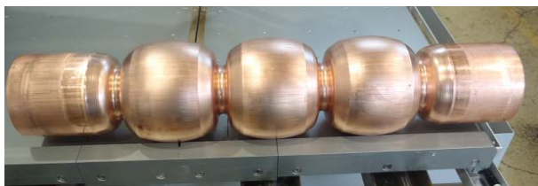
図 6 中間液圧成形を行った銅 3 連空洞
