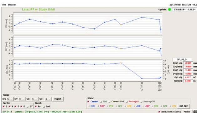
図 7 入射器のビーム輸送時の BPM 信号測定結果
