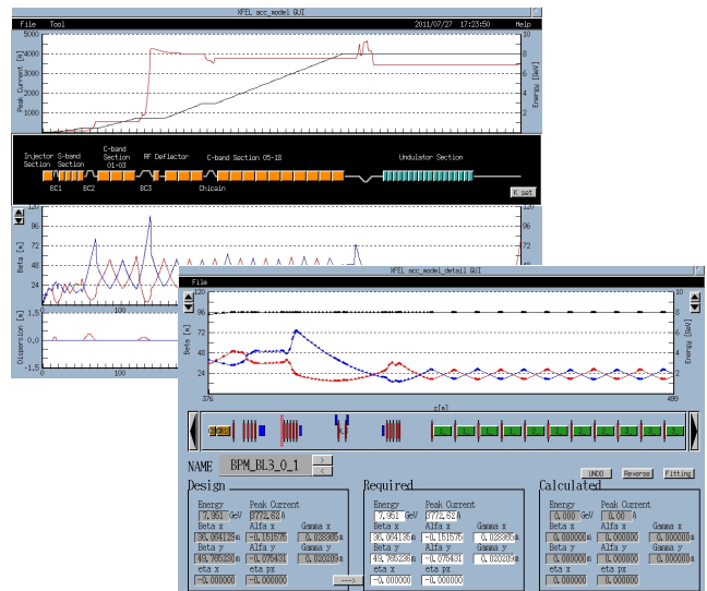
図 3: SACLA 加速器のビームエンベロープ計算用 GUI (図のベータ関数は設計パラメータ)
