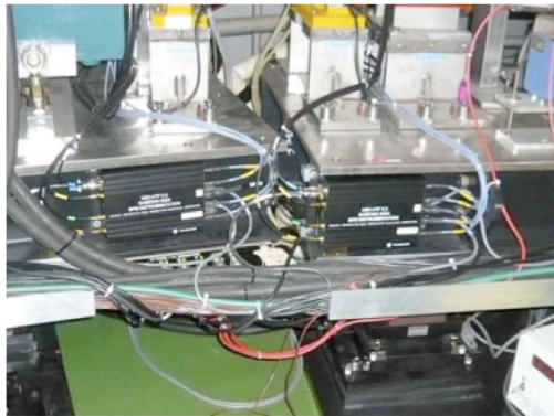
図 5 : ビームラインに設置された BPM 信号用 Down Converter (FNAL 製)
