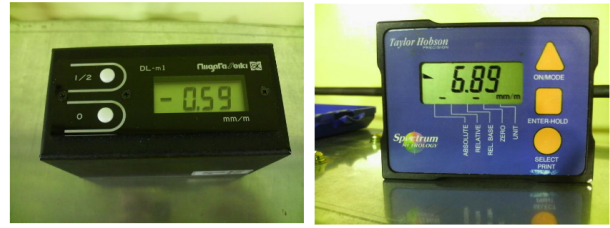
図 4: デジタル傾斜計 (左: 新潟精機、右: Taylor Hobson)
