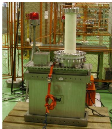
図3：高電圧発生装置。電圧導入部自体を放射線耐性の高いセラミックにした。
