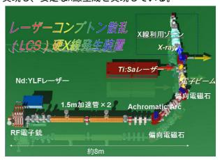
図1: Sバンド小型リニアックを用いた レーザーコンプトン散乱 X 線発生装置
