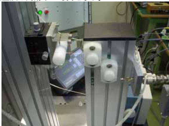
図3：Wire位置決め滑車（始点）
