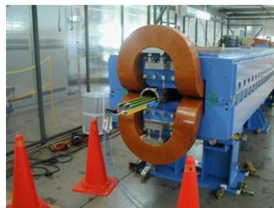
図9 変動磁場測定
