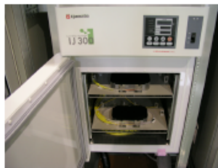
図4：恒温槽の中に置かれた17分岐光カプラ。クライストロンギャラリー最上流19"ラックに設置。
