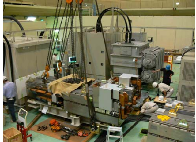
図9：セプタム電磁石着脱時の位置再現性試験
