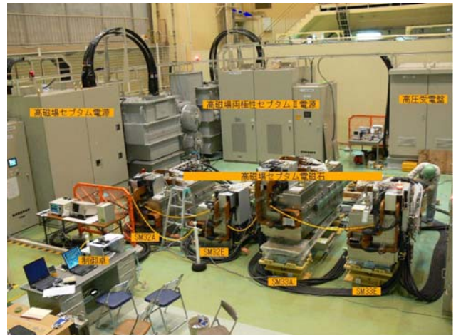
図10：実負荷通電試験の始まった高磁場セプタム電磁石32A, 32E, 33A, 33E (左から)
