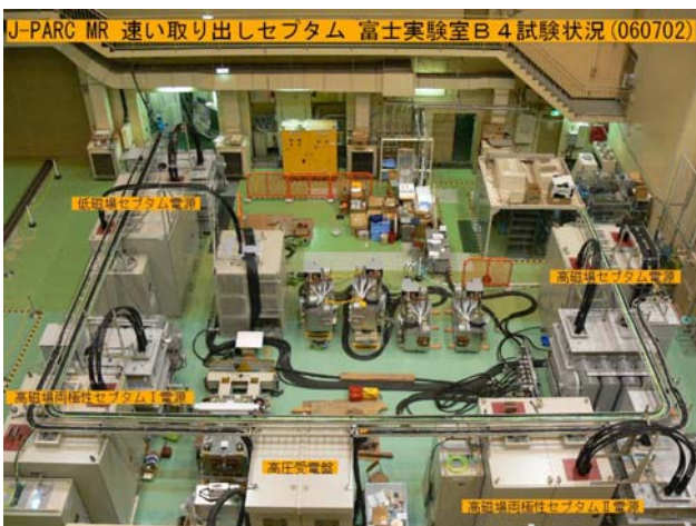
図8：富士実験室地下4階ホールでのセプタム電磁石・電源試験状況
