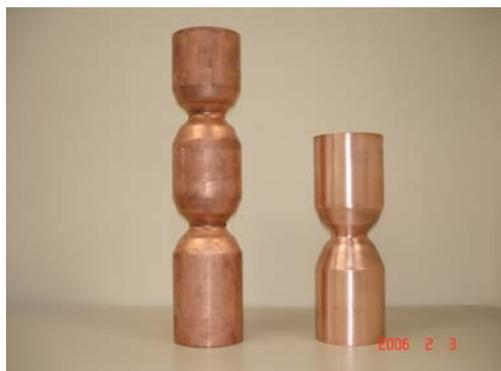
図1 パイプ材から絞り工程後の素材
