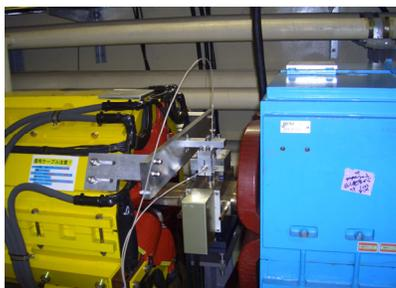
図6 6極マグネット近傍のBPMに取付けた変位計
