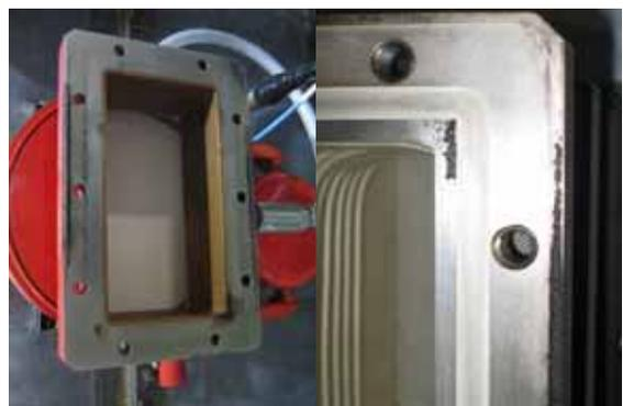
写真3:フラットフランジとOリングフランジ放電痕面の研磨とOリング交換を行った。
