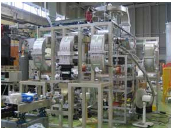
写真2:STF導波管-電力切り替え部
