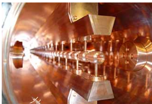
図4：APF方式IH型DTLの内部構造
