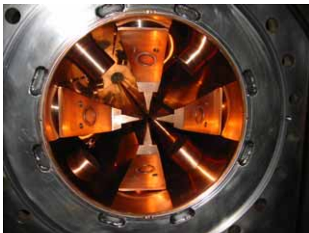
図2：RFQ線形加速器の内部構造
