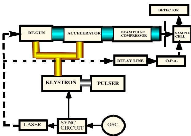
Fig. 1 18MeV LINAC (PHOTO CATHODE RF-GUN) AND PULSE RADIOLYSIS SYSTEM
