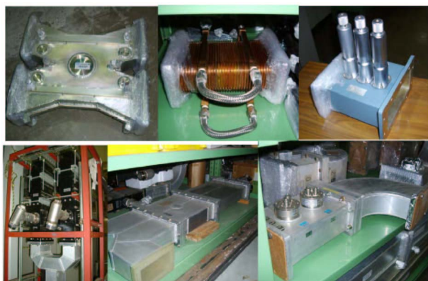
図2 移管導波管の例。右上より3dBハイブリット、フレキシブル導波管、3スタブチューナー、可変短絡板、方向性結合器とHベンツ。
