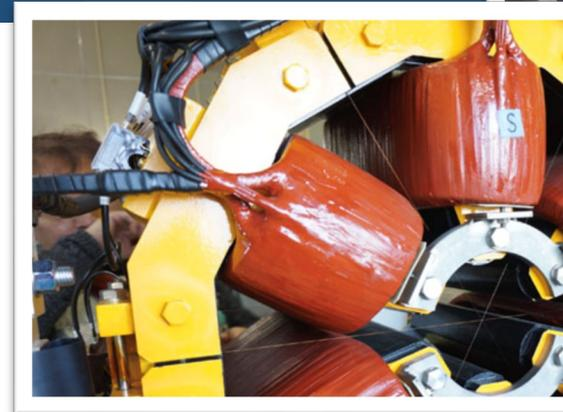
1. 対向する磁極間の隙間にベリリウム銅合金のワイヤー(直径0.1mm)を張り、交点を磁極中心とする。
