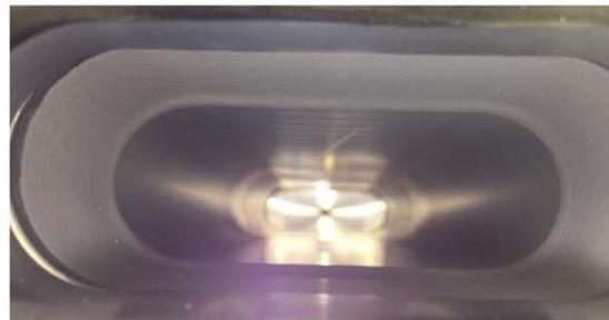
図 3.7 ダクト内壁の Ti コーティング
