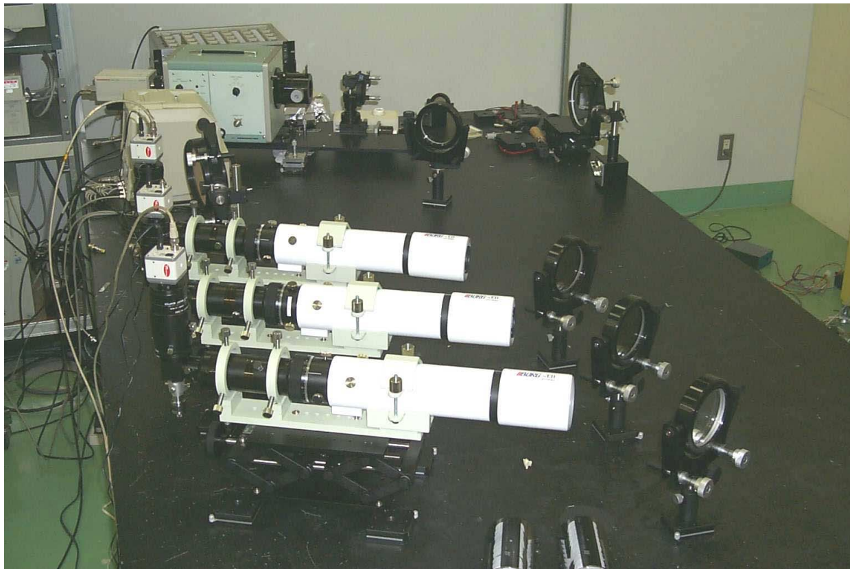
図 2 : 光学台の上に組み立てられた望遠鏡周辺の構成とミラーの配置
