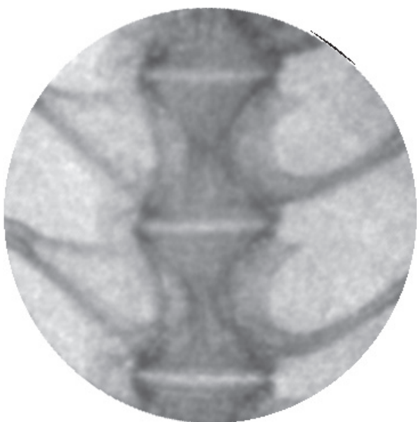
図 2: LCSX 線によって取得したホッケの背骨像
