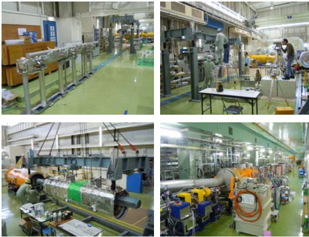
図1：超伝導空洞の連結時の様子（左上）、アライメントの様子（右上）、クライオモジュールに組み込まれる様子（左下）、STFトンネルへの設置（右下）。
