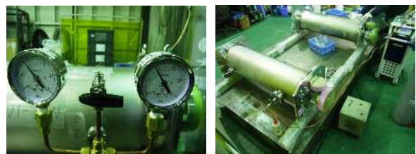
図 9：空洞ジャケット化後の高圧ガス保安協会立会い検査の様子
