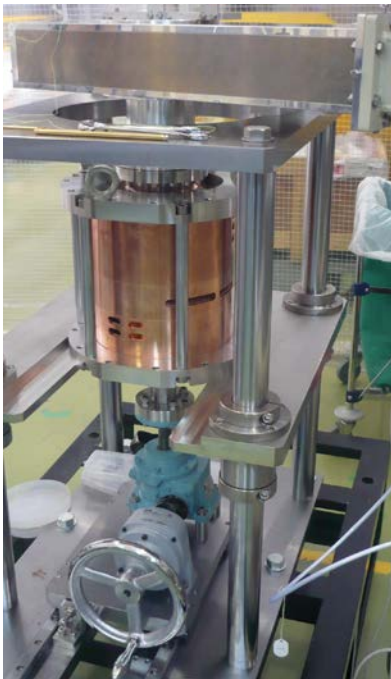
図1：周波数調整器と調整中の電子銃空洞の様子。陰極側調整時は、RF 入力結合器試作器を利用して共振周波数を測定し、出口側調整時はアンテナ結合器を利用する。
