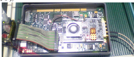
図5 空洞シミュレーター
