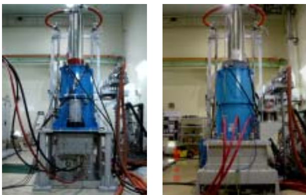
図2．初号機オイルタンク（左）と実機対応オイルタンク（右）の外観
