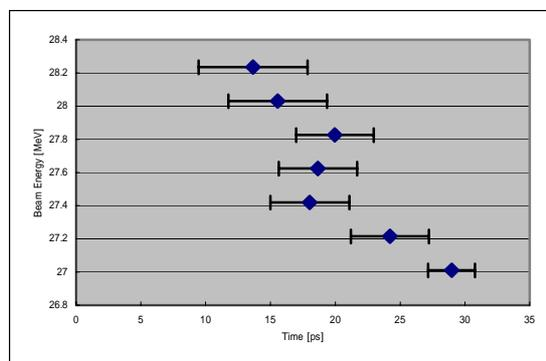
図5：RFクレストの後方で加速された電子の位相空間分布。
