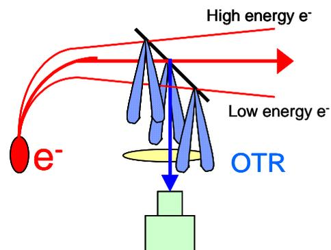
図1: OTRを用いたエネルギー測定概念図。
