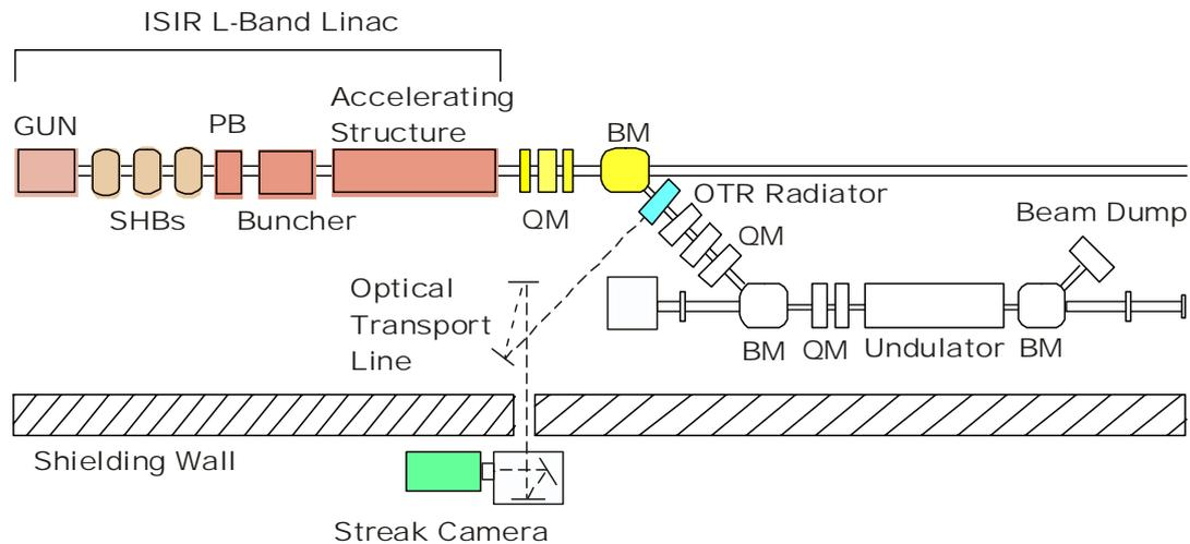
図2：OTR発生部からストリークカメラまでの光学輸送系の配置図。
