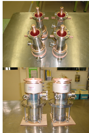
図4：低温部同軸カップラー (上) および室温部同軸カップラー (下) からなる高周波入力結合器
