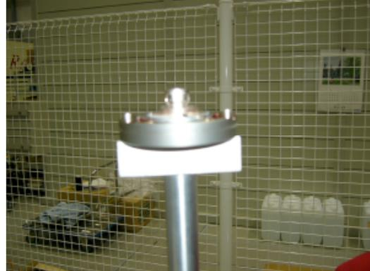
図5. カソード交換治具の写真
