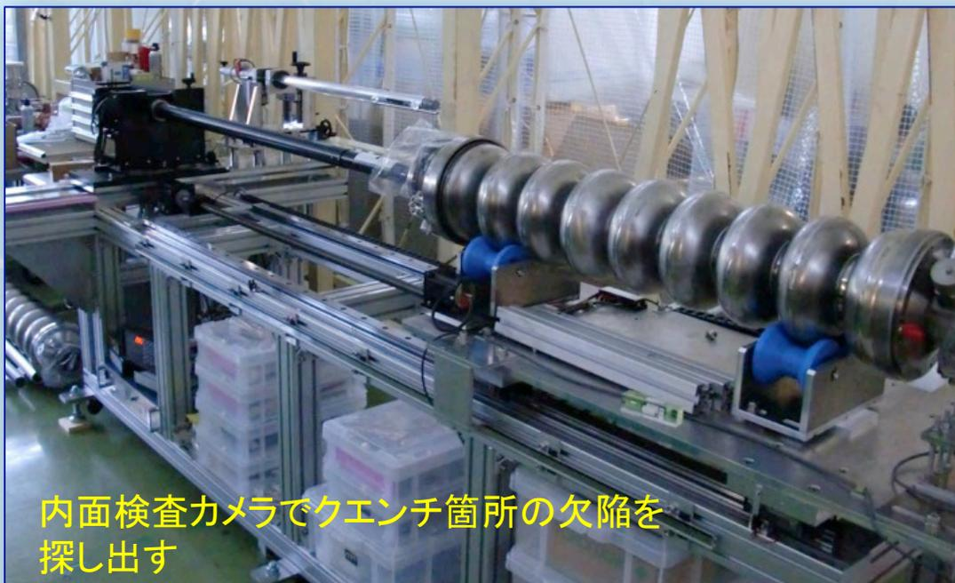
内面検査カメラでクエンチ箇所
