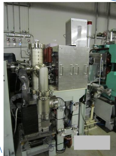
第2高速補正キッカー L = 0.22m, @ \beta_x = 32m
