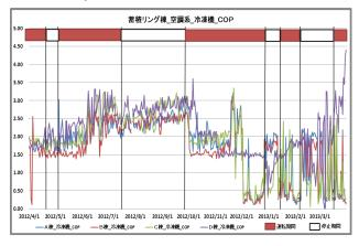
図8:蓄積リング棟空調系冷凍機 COP
