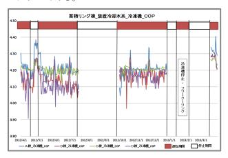
図 7: 蓄積リング棟装置冷却水系冷凍機 COP
