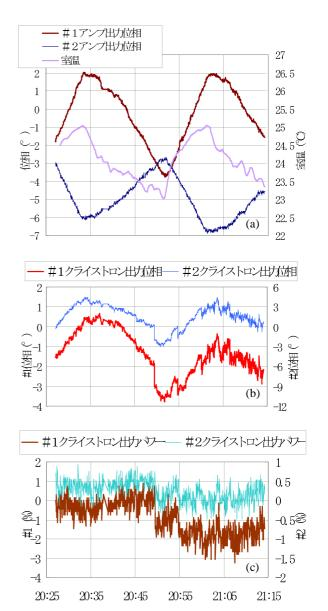
図1:室温と位相補償前のRFの変動 (a) アンプ出力位相、(b) クライストロン出力位相 (c) クライストロン出力パワー ※(a)、(b)、(c)ともに横軸は共通時刻。
