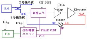
図2:位相補償システムのブロック図
